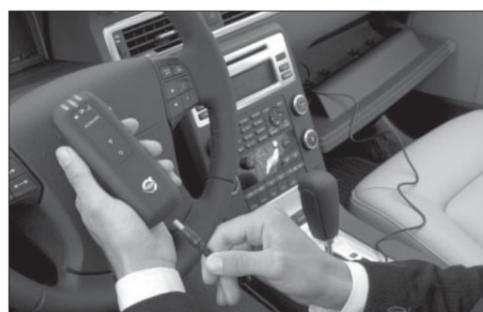
метр, включенный в цепь зажигания автомобиля. Это система аппаратно-программных средств, позволяющая оптимально организовать контроль за трезвостью водителя и препятствующая движению автомобиля, управляемого нетрезвым водителем. Система "Алкозамок" обеспечивает достоверное обнаружение алкоголя в организме, блокировку включения зажигания в случае обнаружения алкоголя, учет попытки несанкционированного запуска двигателя, контроль за трезвостью водителя во время движения.
